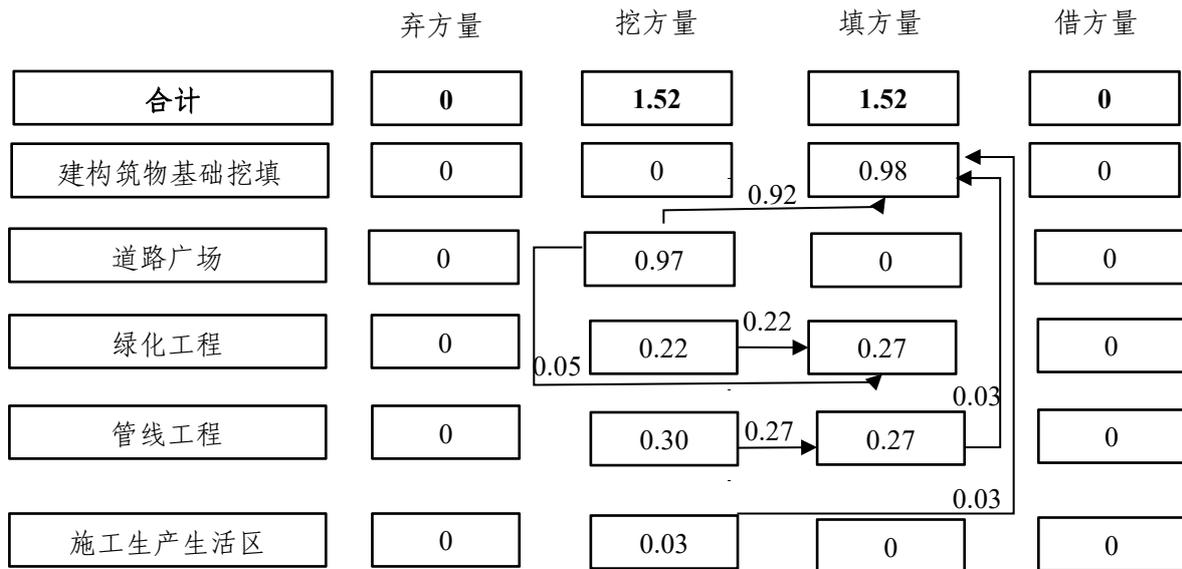
图 1.1-8 项目建设土石方平衡流向图 单位: 万  $m^3$
