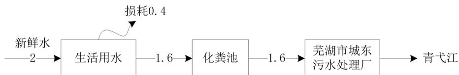
图 4-4 项目水平衡图 (单位: t/d)
